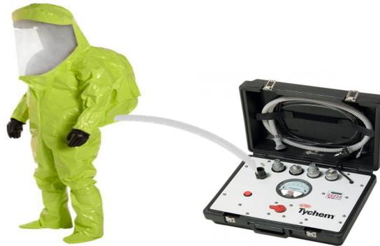
La prueba de sellado en los trajes encapsulados, se debe realizar cada seis meses o si visualmente se ha detectado alguna anomalía. Esta prueba con equipo calibrado asegura que no existan perforaciones y que sea seguro usar el traje.
